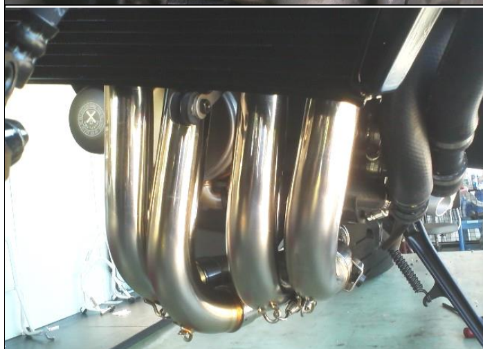
クリップナット M6、ボタンボルト M6x10 にてEXジョイントパイプ同士が干渉しないように固定して下さい。
