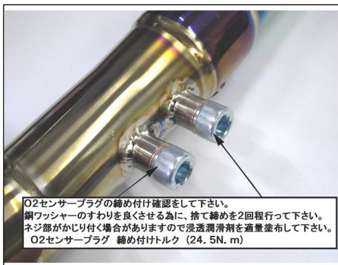
O2センサープラグの締め付け確認をして下さい。
