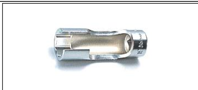
⑥ O2センサー脱着工具 ホンダ純正指定: SNAP-ONFRXM17 同等品: KO-KEN 3300FN-17 O2センサー締め付けトルク 24.5N・m
