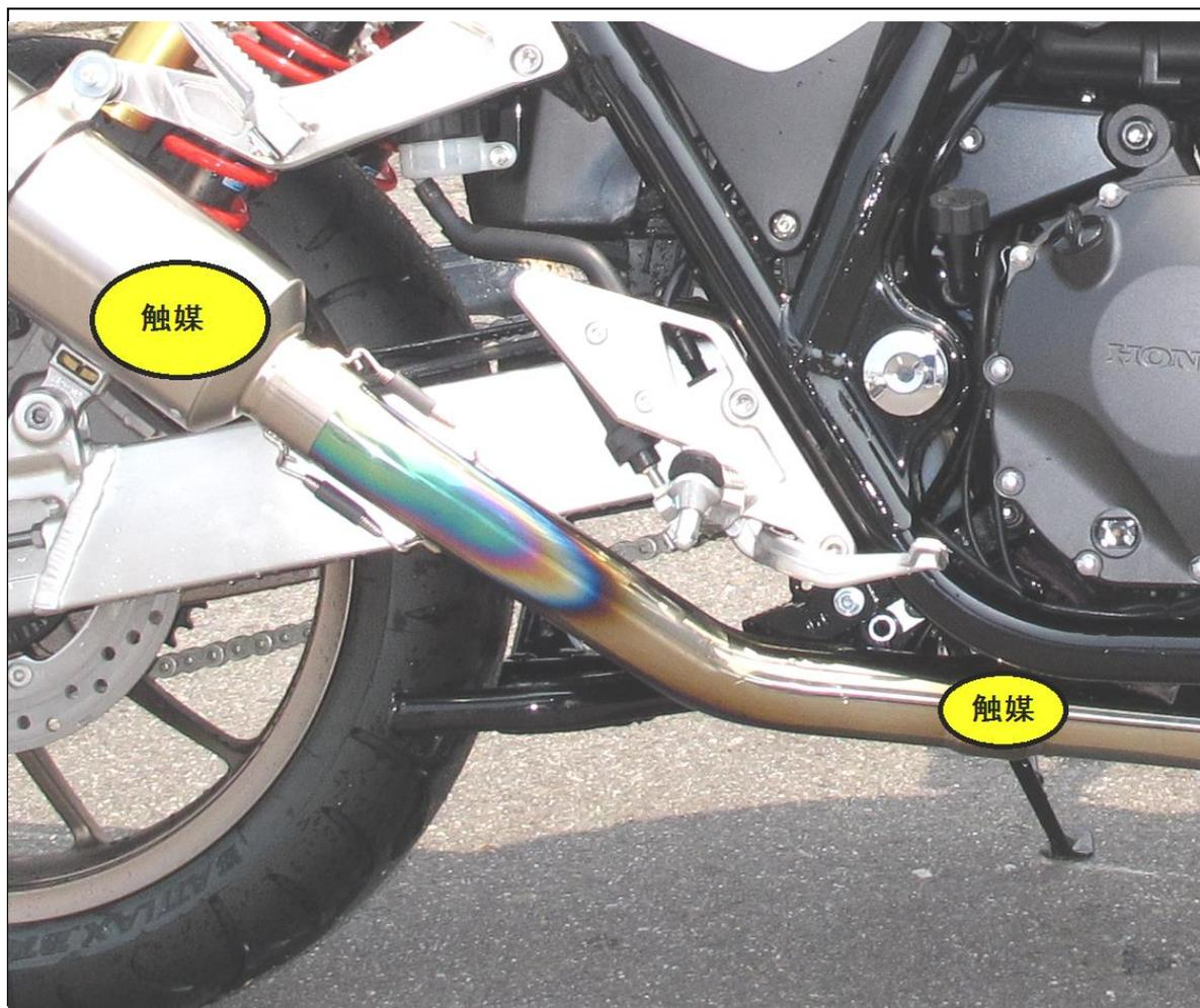
**触媒はエキゾーストパイプC 及びサイレンサーIN 側に装着されています。**
