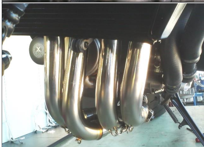
クリップナット M6、ボタンボルト M6x10 にてEXジョイントパイプ同士が干渉しないように固定して下さい。
