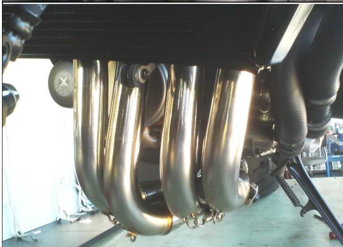
クリップナット M6、ボタンボルト M6x10 にEXジョイントパイプ同士が干渉しないように固定して下さい。
