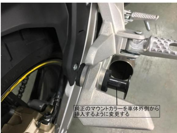
純正のマウントカラーを車体外側から挿入するように変更する
