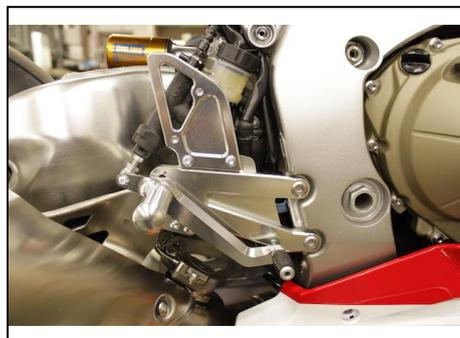
ステップASSYを車体に取り付け、ブレーキペダルの高さやブレーキスイッチの点灯タイミングを調整する。サイレンサーのステーはマフラーマウントカラーのスイングアーム側に接するように取り付けます。ナットは純正部品を再利用します。図⑨参照
