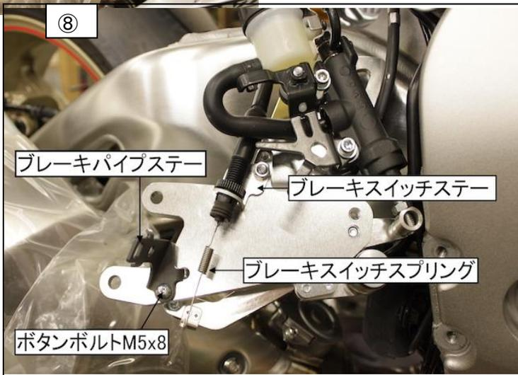
ブレーキペダル、ステップバーをステッププレートに取付ける。ヒールガード前側の取付けボルト内側にブレーキスイッチステーを取付けます。
