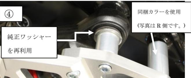
**1. ノーマルタンデムステップの取り外し・ベースプレート取付け**
